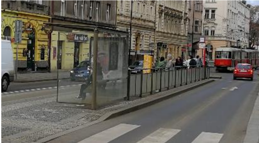
Obrázek 54: Zastávka na ostrůvku opatřená zábradlím a přístupná přes přechod pro chodce [foto Krčál]
